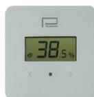
Termostato ambiente vía radio, permite la modificación de la temperatura directamente desde el propio termostato durante un tiempo o permanentemente, sin tener en cuenta la programación de la Placa Base. Desconecta el xxx cuando en modo frío la humedad relativa supera la prefijada en el termostato, para evitar condensaciones.
