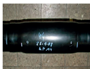
11. Realizar los dos orificios para rellenar con la espuma.
