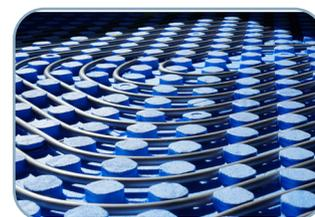
3. El tubo siempre se coloca en forma de espiral dejando libre al menos una hilera de tochos con el fin de colocar el retorno del circuito (ver Tabla1). Así una vez se llega al centro, se vuelve con el tubo por los tochos libres entre dos filas de tubo ya colocados, para completar el circuito.
