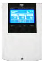
Centralita para control de temperatura de agua a los circuitos en frío/calor con sondas. Permite determinar la curva de caldeo de calefacción y temperatura de impulsión en frío. Se puede programar temperatura de confort y temperatura reducida en calor. Salida para servomotores proporcionales en 3 puntos. Incluye sonda exterior, sonda impulsión. Control de bomba de circulación. Posibilidad de manejo a través de App. (Grupo hidráulico, servomotor y acceso a ruter no incluidos)
