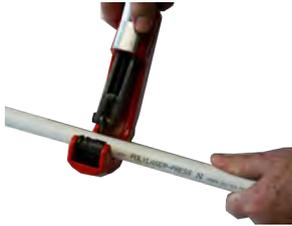
1. Hacer el corte perpendicular al tubo para ello utilizar siempre corta-tubos.
