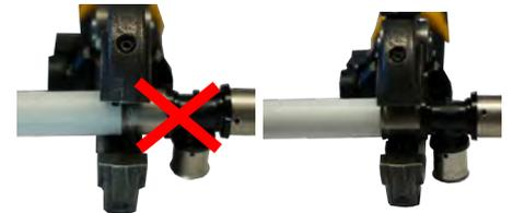
5. Insertar la cuna adecuada al diámetro exterior del tubo que se está conectando. Colocar la boca de la prensa centrada en el casquillo, pegando a la arandela. (No prensar nunca fuera del casquillo).
