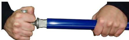
**2a.** Calibrar y matar la arista del tubo para que no dañe las juntas al introducir el accesorio. Hasta Ø32. Se puede calibrar manualmente o con máquina.
