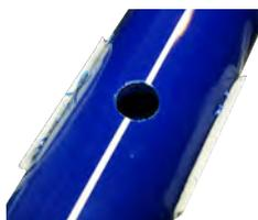
4. Limpiar la zona de soldadura y la pieza a soldar, con un producto de limpieza apto para polietileno.
