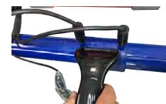
8.- Seleccionar sobre la máquina el diámetro y el tiempo de soldadura. Si usamos el lector de códigos de barras, comprobar que los datos que aparecen en la pantalla son los correctos antes de empezar el proceso de soldado.
