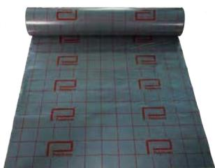
Film de polietileno que se instala debajo del aislamiento como barrera anti-vapor en aquellas zonas que se encuentren en contacto con el terreno, o en las que existan problemas de condensación.
