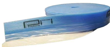
Banda de espuma de polietileno auto-adhesiva que se instala en forma de rodapié en todos los paramentos verticales para absorber las dilataciones de los pavimentos y eliminar los puentes térmicos con los cerramientos. Incorpora un film de polietileno para evitar la filtración de mortero entre el aislamiento perimetral y aislamiento del suelo.
