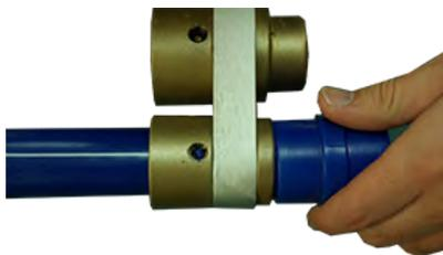
4.- Señalar la posición deseada de la pieza haciendo una marca en la tubería y/o en el accesorio o utilizar la raya longitudinal del tubo.
