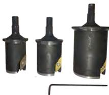
Calibra el diámetro interior del tubo y rebaba la arista para que al montar el accesorio no dañe la junta.
