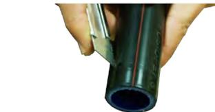
2.- Pré-cortar sobre a camada exterior doem chegar a tocar no tubo em sentido longitudinal e radial sobre a marca de profundidade de soldadura.
