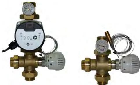
Válvula mezcladora termostática para control de temperatura de agua de calefacción a punto fijo en instalaciones de suelo radiante. Fabricada en latón con racores de 1" rosca macho, termómetro en impulsión, sonda de inmersión y porta-sondas de 3/8".
