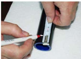
1.- Marcar la longitud de corte según el diámetro de la tubería (ver tabla de profundidad de soldadura, pág.25)
