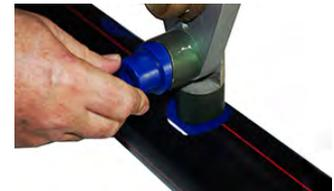
1. Marcar sobre el tubo la zona donde se va a colocar el inserto.
