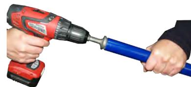
**2b.** Calibrar y matar la arista del tubo para que no dañe las juntas al introducir el accesorio. Para Ø mayores de 32 calibrar siempre con máquina
