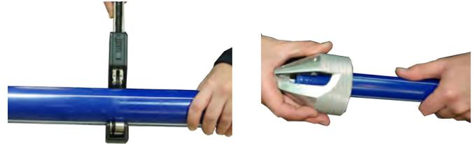
2.- Cortar el tubo perpendicularmente a la generatriz y achaflanar el extremo cortado exterior e interiormente. Antes de soldar el tubo con las piezas, limpiar las zonas de unión (tubo y piezas) con el producto de limpieza para polietileno (PE), y asegurarse que las matrices estén limpias sin ningún resto de material de la soldadura anterior .
