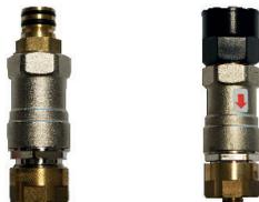
Válvulas para cierre de los circuitos en frío, cuando el agua baje a 19°C evitando de esta manera la condensación en el suelo de los locales húmedos.
