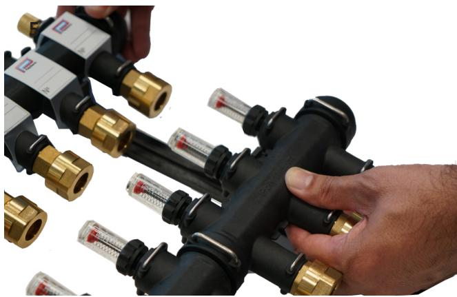
5.- Colocar el colector sobre los soportes.
