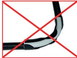
En la curva a 90º hacia la pared, usar codos guía con apoyo trasero para evitar el chafado del tubo por dilatación.
