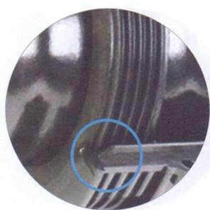
5. Limpiar perfectamente la superficie de Pegado, y aplicar una línea de pegamento de 4 mm, pero solo en la media carcasa inferior.
